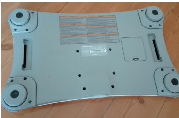
Abb. 28: Nintendo Wii Balance Board: Unterseite mit vier Standfüßen, an welchen jeweils eine Wägezelle montiert ist
