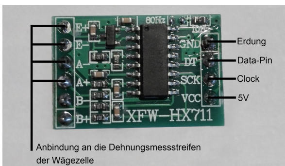
Abb. 21: Abbildung eines HX711-Moduls mit den entsprechenden Pins zum Lesen von Gewichtsdaten
