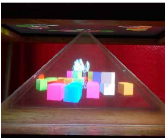
Abb. 49: Photographie des Pyramiden-Aufbaus ohne Beschichtung bei geringem Umgebungslicht
