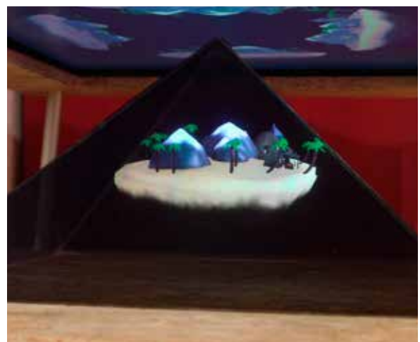
Abb. 56: Photographie des Pyramiden-Aufbaus mit Beschichtung des Plexiglases mit Quantum 16
