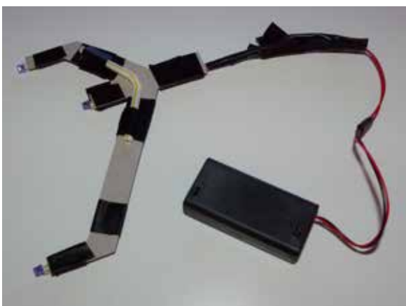
Abb. 44: Infrarot-Sender bestehend aus drei IR-LEDs und Batterie
