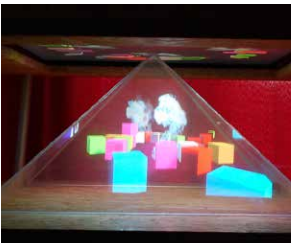
Abb. 55: Photographie des Pyramiden-Aufbaus ohne Beschichtung des Plexiglases
